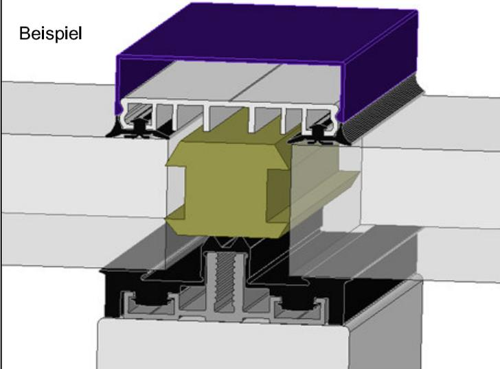
**Alu-Auflageprofil für 3 Fach Glas unter 1,0Ug mit 80 mm Unterkonstruktion, großer durchgehender Dichtung und Isolierkern. Beispiel mit 54mm Glas**
