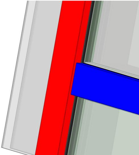
**Fassadenverglasung bei Kaltfassade mit ALU- Auflageprofil für 60 mm (Beispiel) Querriegel bei senkrechter Verglasung !**
