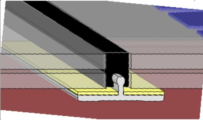
Glasstoß für VSG Glas oder Solarglas **bei flachen Dachneigungen**. Keine überstehende Kante oben. Nur für Kaltverglasungen !
