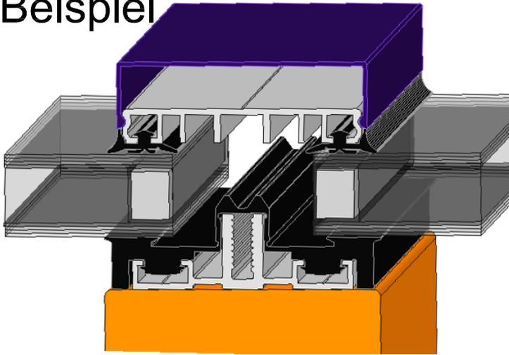
**Alu-Auflageprofil** für 100 mm Unterkonstruktion mit großer durchgehender Dichtung (z.B. Senkrechte Glaswand)
