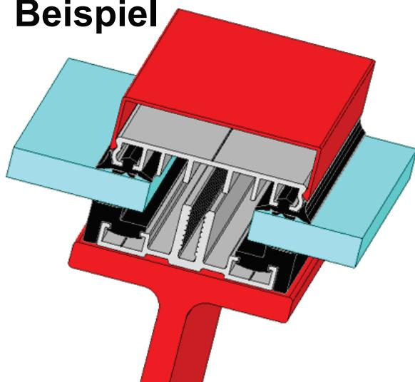
Einfachverglasung mit ALU-Auflageprofil für 60 mm Stahl Unterkonstruktionen
