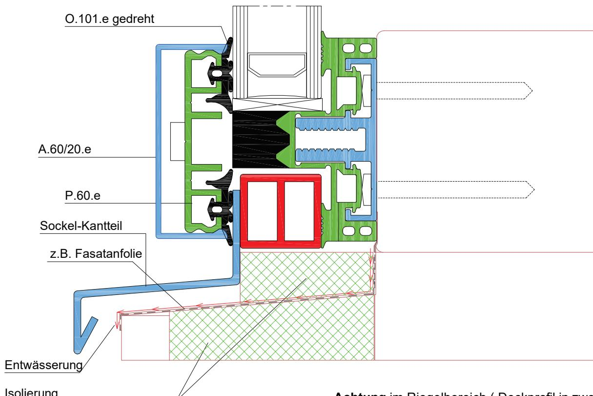
**Achtung** im Riegelbereich ( Deckprofil in zweiter Klickebene) nur Schrauben ohne Dichtscheiben verwenden
